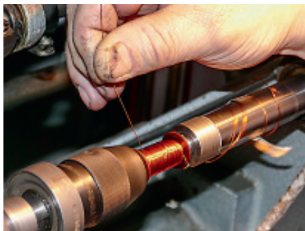
Gewusst wie: Nicht nur die Windungszahl, auch die Wickelrichtung und die „Steigung“ beim Wickeln entscheiden später über die Funktion
