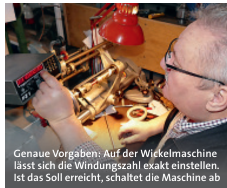
Das Wickeln der Spule ist eine Wissenschaft für sich: Drahtstärke, Wickelmuster und Material müssen stimmen, das Zählen der Windungen übernimmt die Maschine
