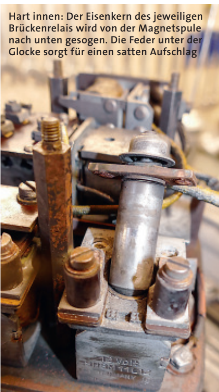
... „Glocke“ noch 1,5 bis 1,8 mm weiter drücken lassen. Die Kontakte sind mit je zwei Schrauben befestigt und lassen sich leicht entfernen. Dabei aber auf keinen Fall die isolierenden Bakelit-Teile beschädigen
