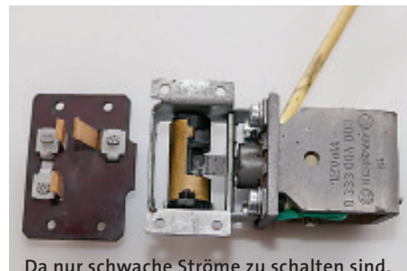
Da nur schwache Ströme zu schalten sind, genügt ein einfacher Walzenschalter mit Schleifkontakten. Der Betätigungsbolzen dreht die Walze wechselweise
