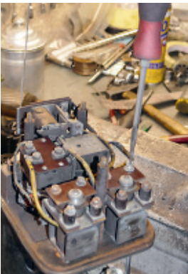
Hart innen: Der Eisenkern des jeweiligen Brückenrelais wird von der Magnetspule nach unten gesogen. Die Feder unter der Glocke sorgt für einen satten Aufschlag
