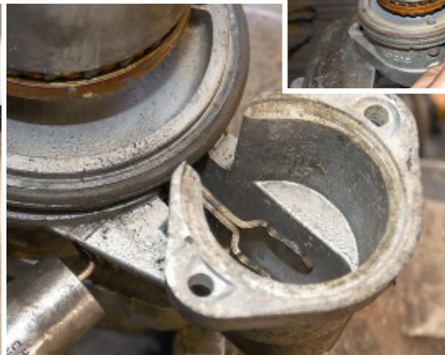
Per Exzenterwelle erhält der Schraubtrieb seine Feineinstellung
