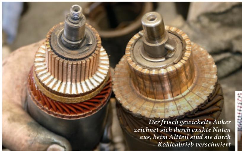
Der frisch gewickelte Anker zeichnet sich durch exakte Nuten aus, beim Altteil sind sie durch Kohleabrieb verschmiert
