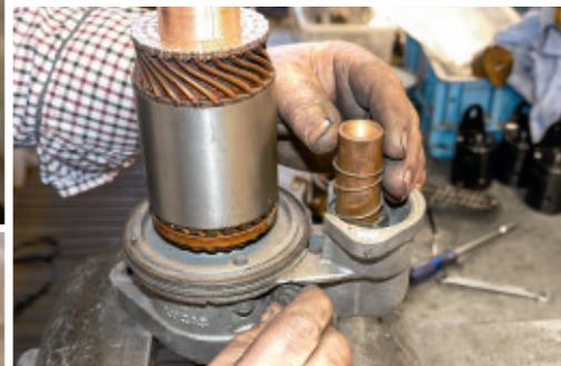
Beim Zusammenbau hängt Jahn den Kern des Magnetschalters in die Ausrückgabel ein
