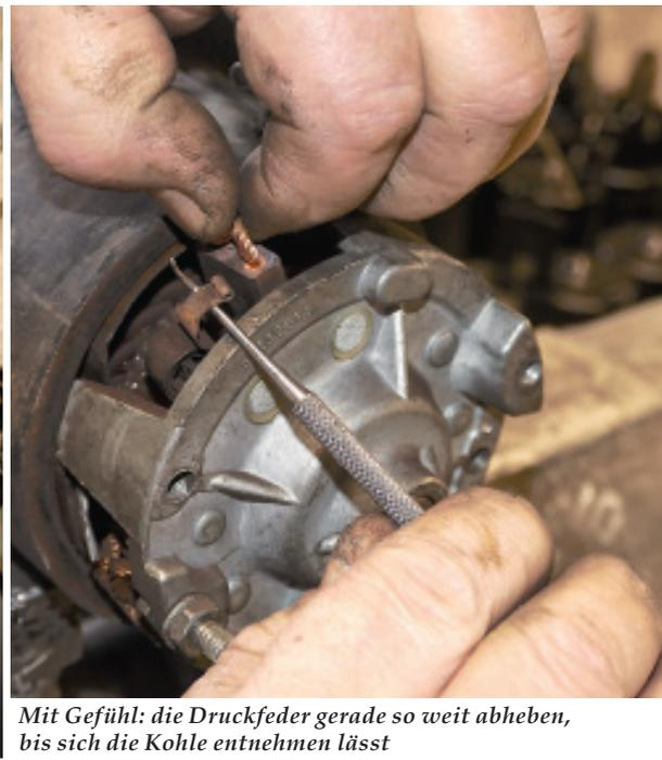
*Mit Gefühl: die Druckfeder gerade so weit abheben, bis sich die Kohle entnehmen lässt*
