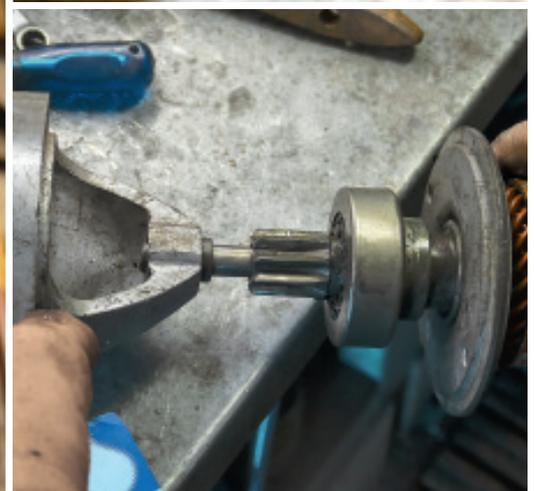
Die vordere Lagerbuchse prüft Wilhelm Jahn durch Einstecken der Ankerwelle
