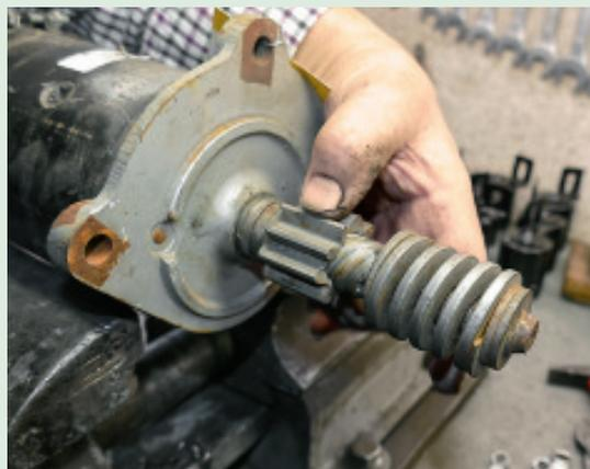
Der Freilauf des Anlasserritzels ist normalerweise sehr langlebig, doch zur Veranschaulichung wollen wir ihn öffnen. Die Einheit aus Ritzel und Freilauf sichert ein Ring, den eine Schiebehülse am Platz hält. Der Spezialist klopft die Hülse leicht herunter, und schon kann der Ring mittels Spreizzange entnommen werden. Danach nimmt er die Freilaufeinheit ab.
