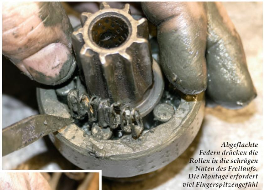
Abgeflachte Federn drücken die Rollen in die schrägen Nuten des Freilaufs. Die Montage erfordert viel Fingerspitzengefühl
