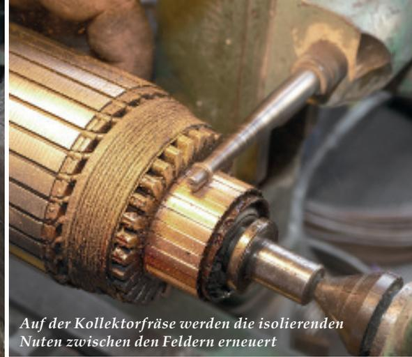
*Auf der Kollektorfräse werden die isolierenden Nuten zwischen den Feldern erneuert*
