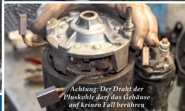
*Achtung: Der Draht der Pluskohle darf das Gehäuse auf keinen Fall berühren*
